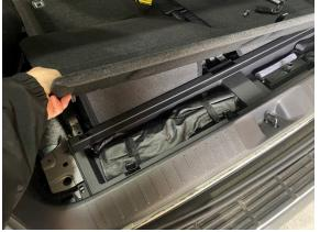
**STEP 1.6** REMOVE REAR TRIM PANEL PULLING BODY CLIPS UP FROM LEFT TO RIGHT AS SHOWN. (CHECK FOR TRIM CLIPS)
