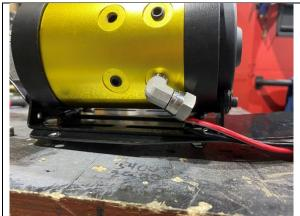
**STEP 2B.1** INSTALL JBA-CB106 90 DEGREE ELBOW IN TO THE 1/4" OUTLET ON THE BOTTOM SIDE AND ORIENTATE AS SHOWN.
