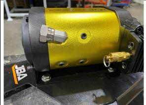
**STEP 2A.1** INSTALL JBA-CB106 90 DEGREE ELBOW IN TO THE 1/4" OUTLET ON THE TOP SIDE AND ORIENTATE AS SHOWN.
