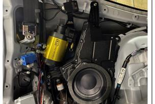
**STEP 3.3** ALIGN THE SUBWOOFER BACK INTO POSITION AND REINSTAL ORIGINAL 4 X TOYOTA M6 SCREWS.
