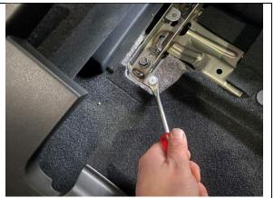
**STEP 1.32** USE A TRIM CLIP REMOVER TO POP OUT OF THE VEHICLE AS SHOWN.
