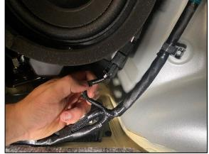
**STEP 1.25** DISCONNECT PLUG FROM BOTTOM RIGHT HAND SIDE OF SUBWOOFER WHERE SHOWN
