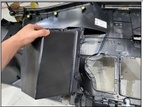
**STEP 1.30** PULL FIRMLY ON 2 X RETAINERS ON RHS AND PULL REAR POCKET OFF TO COMPLETLEY REMOVE AS SHOWN.
